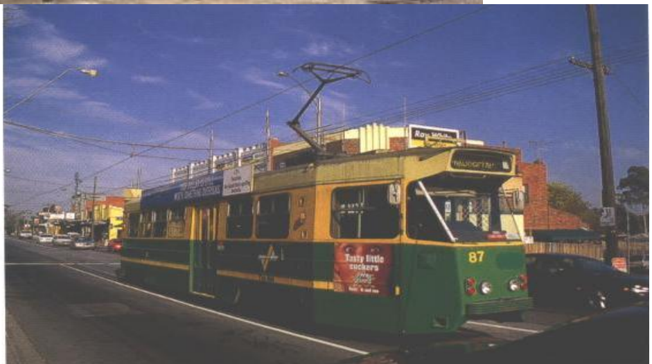
墨爾本的 LRT，使用單臂式集電
