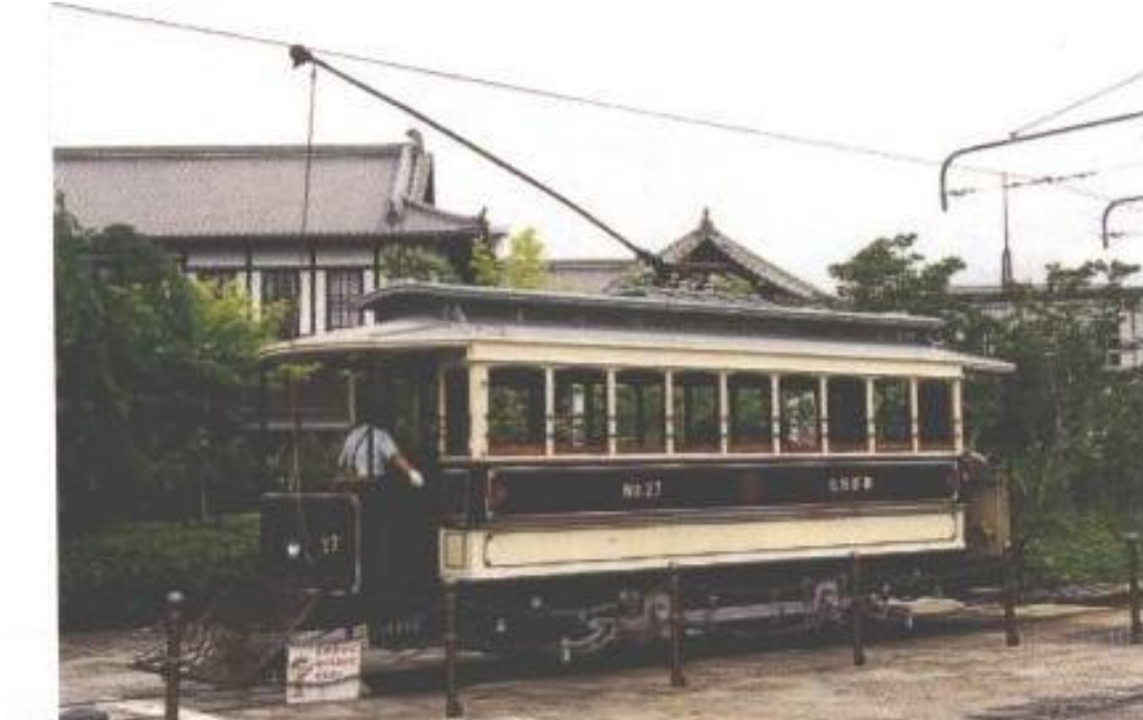
採用集電桿的日本古典路面電車
