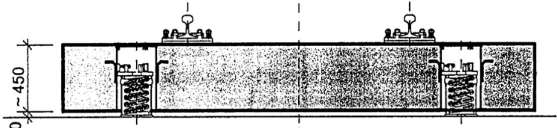
圖21 線圈彈簧支承墊(自然頻率4Hz~8Hz)
